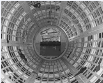
RYS. 2.14 Część robocza obrotowego sita bębnowego [23]
