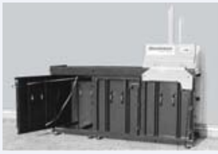
RYS. 2.3 Prasa trzykomorowa; pojemność każdej z komór załadowczych wynosi 0,1–0,3 m 3 [10]
