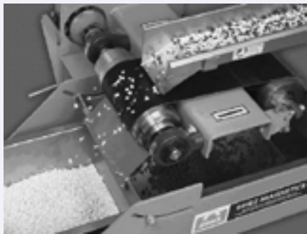
RYS. 2.18 Proces separacji cząstek niemagnetycznych [18]
