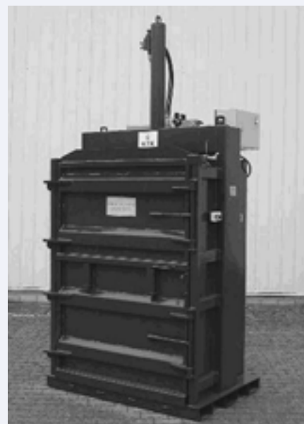
RYS. 2.2 Prasa jednokomorowa; pojemność komory załadunkowej 0,1 m 3 , hydrauliczny napęd stempla [9, 10]
