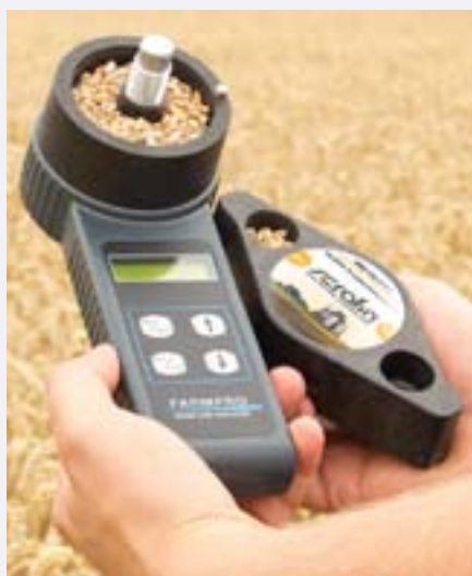
FOT. 1 Wilgotnościomierz do zboża [ZRÓDŁO: Serafin]
