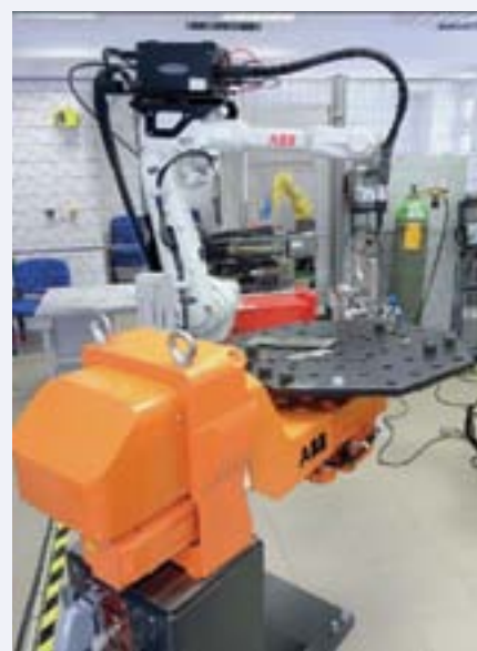
RYS. 2.35 Robot IRB 2600 firmy ABB z zainstalowanym podajnikiem drutu firmy Fronius na stanowisku spawalniczym
