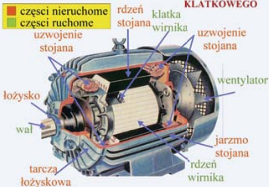
RYS. 1 Silnik asynchroniczny - budowa
